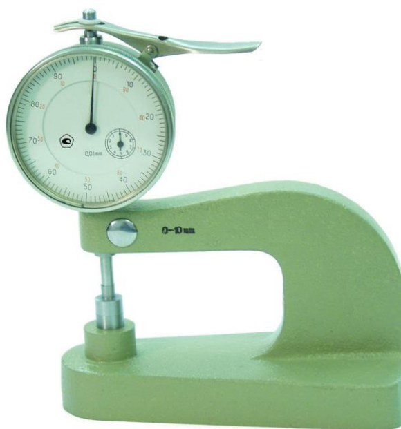
Рисунок 1 – Общий вид толщиномера настольного ТН с нормированным измерительным усилием
