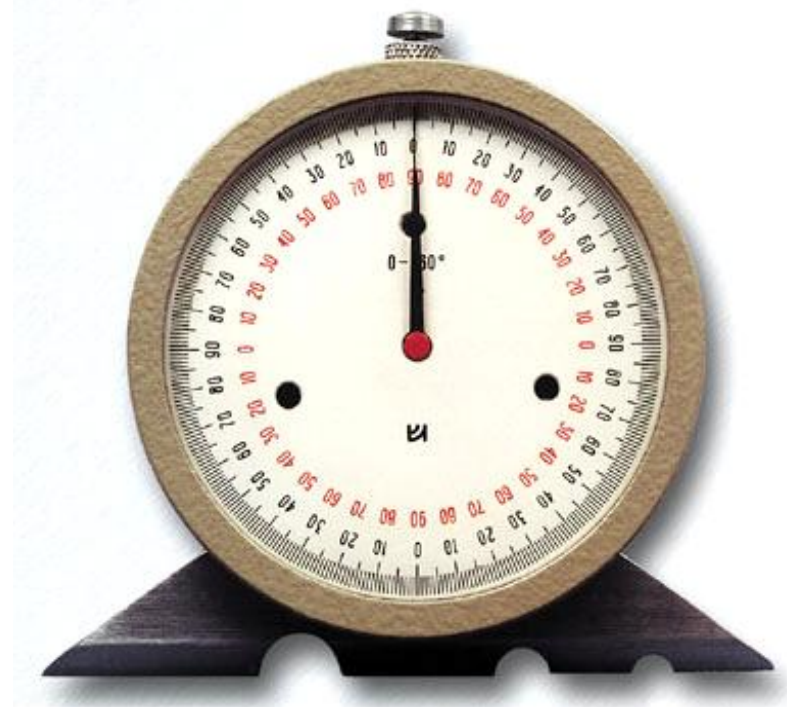
Рисунок 1 - Общий вид угломера маятникового ЗУРИ-М
