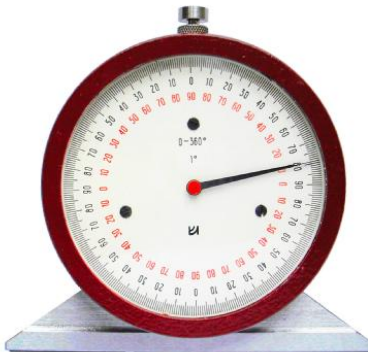
Рисунок 2 - Общий вид угломера маятникового ЗУРИ-Н
