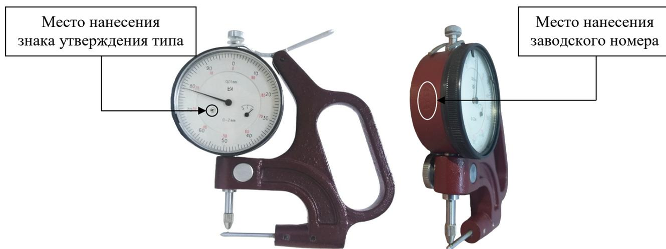
Рисунок 1 – Общий вид стенкомеров С-2, С-10А
