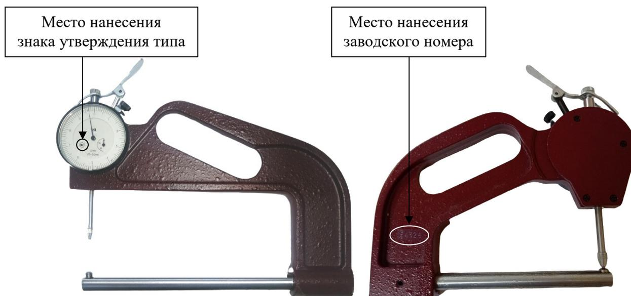
Рисунок 3 – Общий вид стенкомеров С-25, С-50
