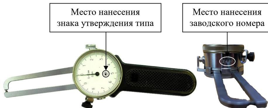
Рисунок 2 – Общий вид стенкомеров С-10Б
