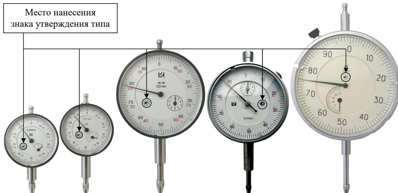
Рисунок 1 – Общий вид индикаторов с указанием места нанесения знака утверждения типа
