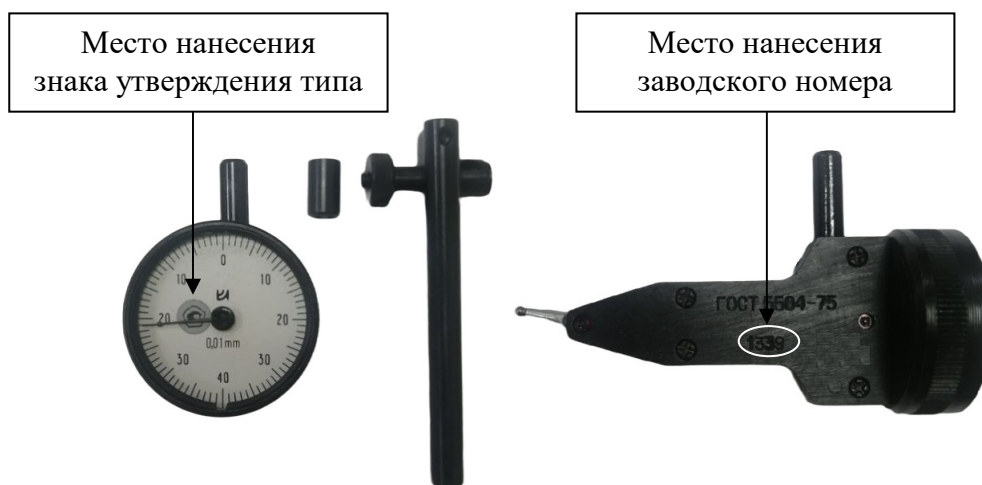
Рисунок 2 – Общий вид индикаторов ИРТ с указанием мест нанесения заводского номера и знака утверждения типа
