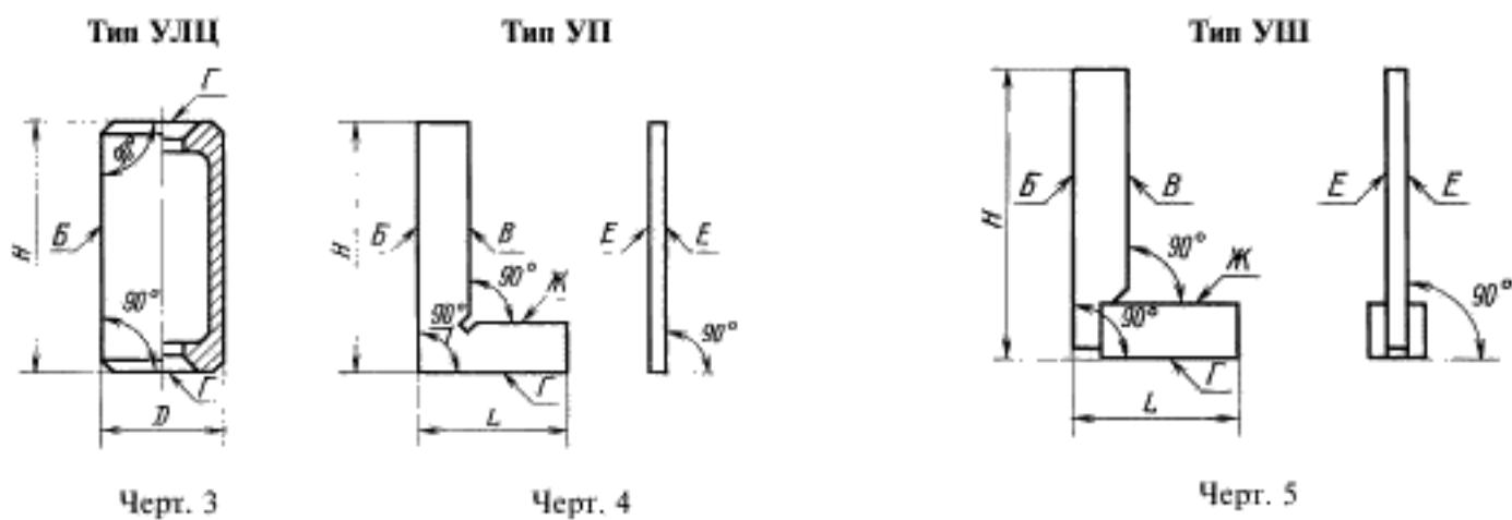
*B, В* — измерительные поверхности угольников; *Г, Ж* — опорные поверхности; *E* — боковые поверхности
